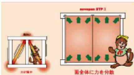
水平方向の力を面全体に分散して受け止めます。
